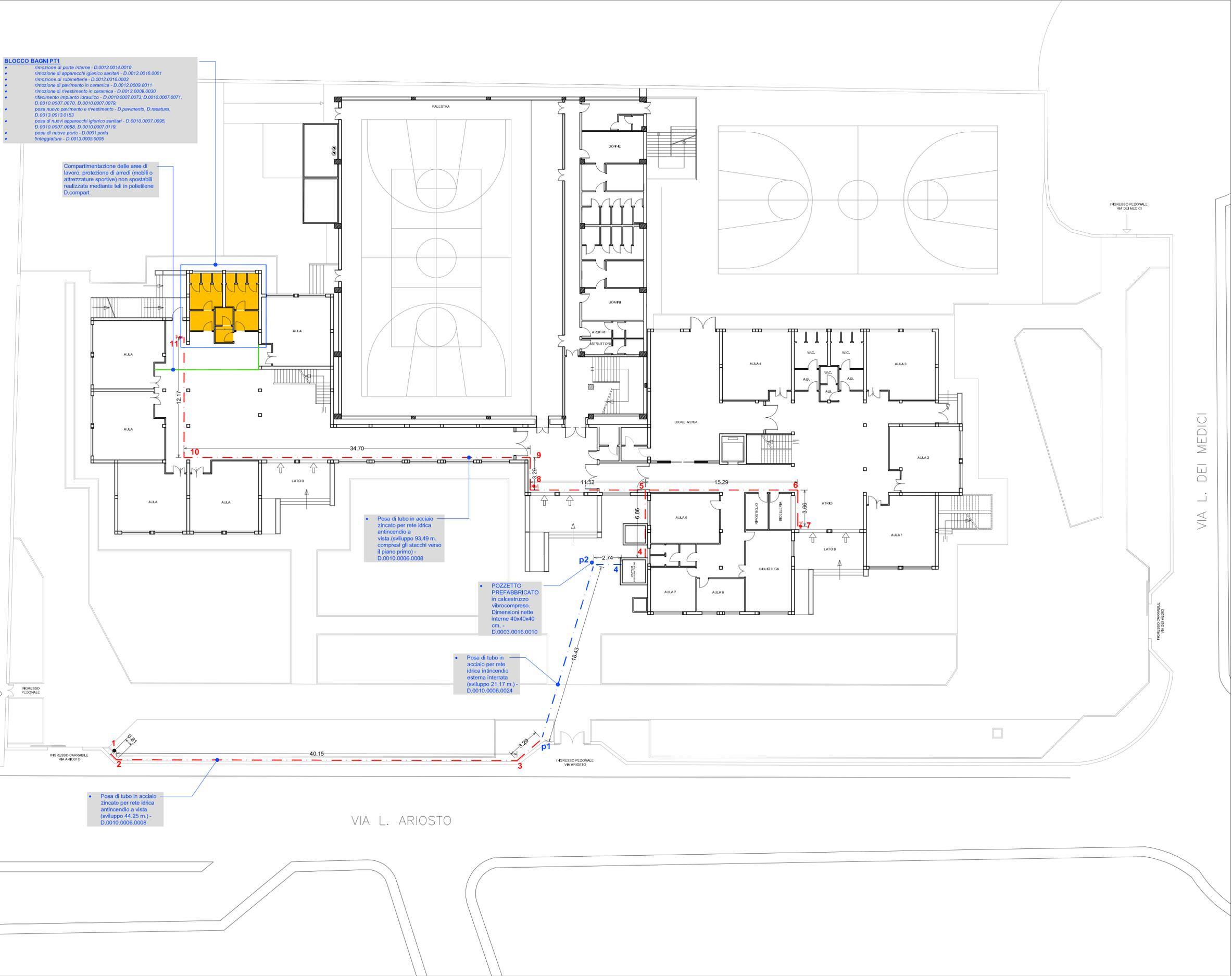
• Posa di tubo in acciaio zincato per rete idrica antincendio a vista (sviluppo 93,49 m. compresi gli attacchi verso il piano primo) - D.0010.0006.0008
