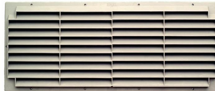
Griglia di areazione in vetroresina per cabine elettriche realizzate in resina poliestere rinforzata con fibre di vetro SMC Colore grigio ENEL, autoestinguente, secondo le prescrizioni ENEL DS 4974. Grado di protezione IP 33 secondo la norma CEI-EN 60529, corredata di rete anti-insetto in acciaio inox con maglia da 10x10mm. e di accessori per il montaggio.
