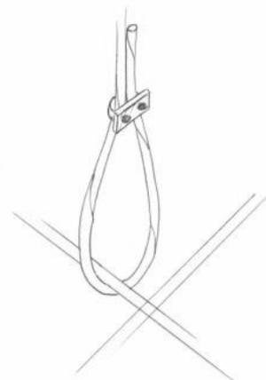
4) Posizionamento della cinghia - Fare passare la cinghia all'interno del primo anello a "D", avendo cura che la cinghia abbracci la zolla in punti solidi e resistenti
